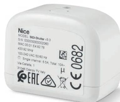
**BiDi-Shutter consente di integrare anche i motori meccanici tubolari nel sistema smart home può funzionare senza gateway e con trasmettitori monodirezionali.**
