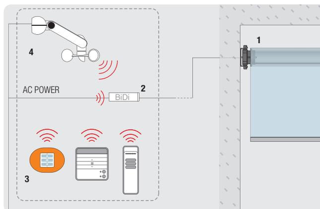
1. MOTORE TUBOLARE 2. CENTRALE BIDI-SHUTTER/BIDI-AWNING 3. TRASMETTITORE 4. ANEMOMETRO RADIO SERIE NEMO
