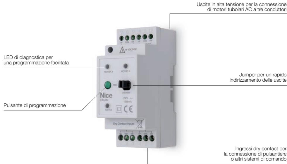
**Modulo DIN di interfaccia motore dotato di 4 ingressi dry contact programmabili e 2 uscite in alta tensione,** per connettere al sistema modulare qualsiasi motore tubolare AC a 3 conduttori presente sul mercato.
