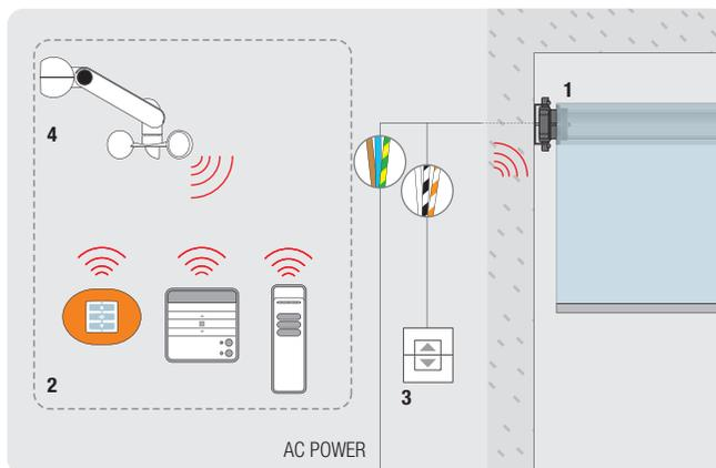
1. MOTORE TUBOLARE 2. TRASMETTITORE 3. PULSANTE "SALI/SCENDI" COLLEGATO AL TTBUS\* O PULSANTE "PUSH BOTTON" CON ERA PLUS MH E ERA PLUS LH 4. ANEMOMETRO RADIO SOLARE SERIE NEMO
