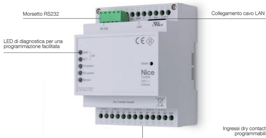
**Modulo DIN di connettività dotato di uscita BusT4, collegamento LAN, morsetto RS232 e 12 ingressi dry contact programmabili, per la gestione di impianti evoluti.**
