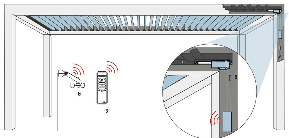
1. Motore 2. Trasmettitore 3. Centrale 4. Modulo alimentazione 5. Sensore temperatura 6. Sensore climatico
