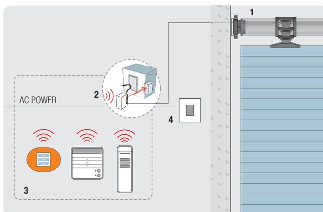
1. MOTORE TUBOLARE 2. CENTRALE MINIATURIZZATA SERIE BIDI-SHUTTER COLLEGATA TRAMITE ALIMENTAZIONE DA RETE 3. TRASMETTITORE 4. PULSANTE "PUSH BOTTON"
