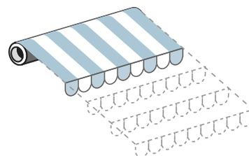
**Possibilità di impostare quote intermedie di apertura** richiamabili tramite trasmettitore. Nelle applicazioni con tende a ganci è possibile utilizzare le quote intermedie in modo da poter sfruttare differenti posizioni di aggancio.
