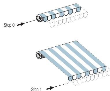
**Possibilità di programmare le posizioni di finecorsa in modo puntuale, anche da trasmettitore.**
