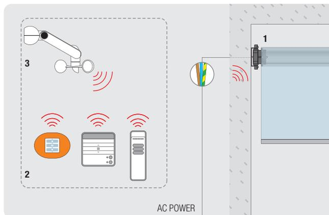
1. MOTORE TUBOLARE\* 2. TRASMETTITORE 3. ANEMOMETRO RADIO SOLARE SERIE NEMO
