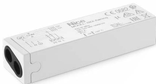
**BiDi-Awning consente di integrare anche i motori meccanici tubolari per tende da esterno nel sistema smart home, può funzionare senza gateway e con trasmettitori monodirezionali.**
