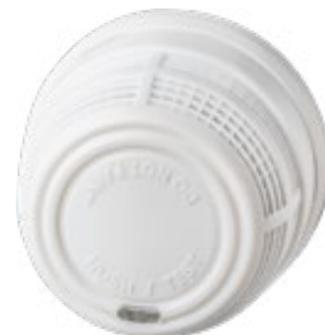
Il sensore a tripla tecnologia ottico di fumo, termovelocimetrico e alta temperatura è adatto alla rilevazione di fumo, alla rilevazione di incendi a lenta progressione dove possono trascorrere anche diverse ore prima che l'ambiente vada a fuoco, e alla rilevazione del gradiente termico, in caso di incendi a rapida o media progressione. Copertura media: 50 mq.
